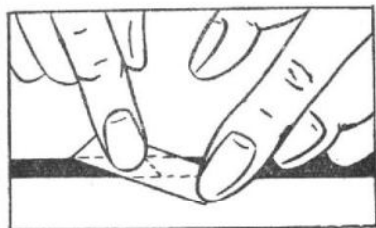
Fig. 1. — Le collage classique des bandes magnétiques
