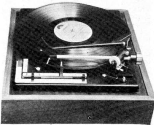
Fig. 4 — BSR UA 75. Cette platine a fait l'objet d'une étude complète dans le Haut-Parleur du 17 octobre 1968 (n° 1 182). Le support du bras permet à cet appareil de fonctionner avec des inclinaisons importantes.
