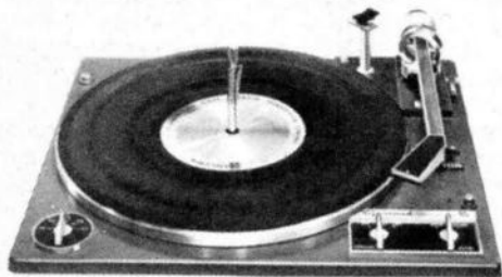
Fig. 2 — Le tourne-disque automatique GARRARD 95. On remarquera l'inclinaison à 45° du support de bras à double cardan. Ce tourne-disque peut être préréglé grâce au bouton de gauche pour fonctionner avec des disques de 25 cm. Le dispositif d'équilibrage des disques est escamotable, il s'enfonce dans le socle de la platine. Le bras carré est composé de métal et de bois.
