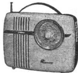
**P1**. Poste à piles 4 lampes (DK96, DF96, DAF96, DL96). 3 gammes PO-GO-OC. 4 boutons poussoirs dont arrêt. Cadre ferrite et antenne télescopique. HP 9 cm. 2 piles 1,5 V 100 mA et pile 67,5 V 8mA. Possibilité d'alimentation HT secteur par bloc incorporable. Plastique ivoire, corail ou vert.
