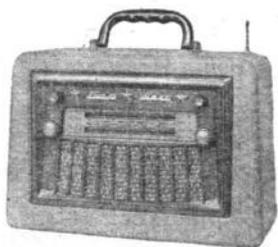
**Far-West.** Poste piles-secteur 5 lampes + redresseur (DK92, 2-IT4, IS5, 3Q4). 4 gammes OC1 - OC2 - PO - GO. Cadre à air et antenne
