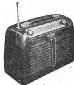
**Week-End,** poste piles-secteur 5 lampes + redresseur (DK92, IS5, 2-IT4, 3Q4, redr. Sélénox. Etage HF 3 gammes OC - PO - GO. Cadre incorporé et antenne télescopique. HP 90 V 14 mA. Tous courants continu ou alternatif. Coffret plastique bordeaux H2220-L305 P135 mm.
