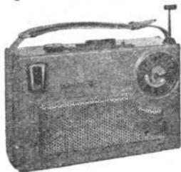
**Miami.** Poste piles-secteur 5 lampes, + 2 redresseurs (DK96, DF96, DAF96, 3Q4, 2 redr. sélénium, DM 71). 3 gammes PO - GO - BE. 4 boutons poussoirs dont arrêt. Cadre ferriloop et antenne télescopique. HP elliptique 10-14 cm. 2 piles 1,5 V 175 mA, et pile 90 V 8 mA. Secteur alternatif. Câblage par circuits imprimés. Coffret gainé cuir H170-L280-P95 mm.
