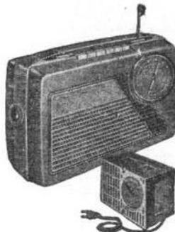
**Pygmy-Golf.** Poste à piles 6 lampes (DK96, 2-DF96, DAF96, DL96, DM70). Etage HF 6 gammes OC1-OC2-OC3-OC4-PO-GO. 6 boutons poussoirs. Cadre ferroxcube et antenne télescopique. HP elliptique 10-14 cm. 3 piles 1,5 V 175 mA et pile 90 V 11 mA. Position économique 8,5 mA. Possibilité d'alimentation secteur par adjonction d'un bloc incorporable. Coffret 2 coquilles ivoire, vert, bordeaux ou gris perle, H195-L280-P98 mm.
