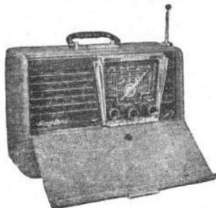
**Sky-Master G standard.** Poste piles-secteur 8 lampes (2-IT4, 2-IU4, IR5, IS5, 3Q4, 117Z3). Etage HF accordé. 8 gammes PO-GO-BE1-BE2-BE3-BE4-BE5-BE-6. Cadre à air et antenne télescopique. Bobinages tropicalisés. HP 17 cm. Tonalité 4 positions. 2 piles 6 V 50 mA et 2 piles 45 V 13 mA. Position économique 10 mA. Tous courants continu et alternatif. Valise bois gainée plastique, H 260 - L 390 - P170 mm.
