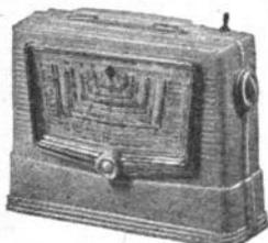
**Capri P.** Poste à piles. 4 lampes (DK92, 1T4, 1S5, 3Q4). 4 gammes OC - PO - GO - BE. Cadre ferroxcube et antenne télescopique. HP 12 cm. 2 piles 1,5 V 250 mA, et pile 67,5 V 9 mA. Possibilité d'alimentation secteur par socle se plaçant sous l'appareil. Polystyrène ivoire, bordeaux ou vert. H170-L265-P80 mm.
