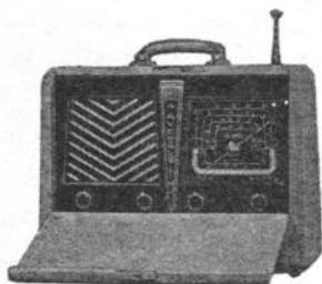
**Waves Glory.** Poste piles-secteur. 5 lampes (DK92, 1T4, 1S5, 3Q4, 117Z3). 4 gammes : OC - PO - GO - BE. Cadre incorporé et antenne télescopique, HP 127 mm. Pile 4,5 V 100 mA et pile 90 V 13,5 mA, position économique 9,5 mA. Secteur tous courants continu ou alternatif. Valise gainée, H 240 - L 320 - P 140 mm. Prix T.T.C. Paris, sans piles **35.940**
