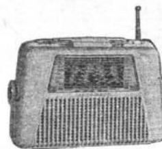
**Pygmy-Club.** Poste à piles 4 lampes (DK96, DF96, DAF96, DL96). 4 gammes OC1-OC2-PO-GO. 4 boutons poussoirs. Cadre ferroxcube et antenne télescopique. HP 10 cm. 2 piles 1,5 V 125 mA et pile 67,5 V 8,5 mA. Possibilité d'alimentation par bloc incorporable. Coffret 2 coquilles ivoire, vert, bordeaux ou
