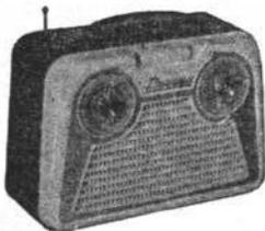
**Escorteur.** Poste à piles 4 lampes (DF96, DAF96, DL96, DK96). 4 gammes OC - PO - GO - BE. Cadre ferroxcube, antenne télescopique. HP 12,5 cm. 2 piles 1,5 V, 100 mA et pile 90 V, 12 mA. Coffret gainé peau H195-L275 - P120 mm.
