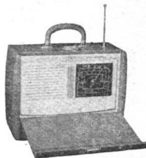
**5625 PS.** Poste piles-secteur. 5 lampes (DK92, IT4, IS5, 3Q4, 117Z3). 4 gammes OC - PO - GO - BE. Cadre ferroxcube et antenne télescopique. HP 127 mm. Pile 4,5 V 100 mA et pile 90 V 14,5 mA (position économique 10 mA). Tous courants continu ou alternatif. Valise gainée H240-L320-P140 mm.
