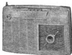
**Jicky-Roadster.** Poste à piles 5 lampes (DK92, 2-IT4, 1S5, 3S4), 3 gammes OC (40-50 m) - PO - GO. Cadre ferroxcube et antenne télescopique. HP 125 mm. 2 piles 1,5 V 300 mA, et pile 67,5 V 13 mA. Position économique 250 mA et 75 mA. Possibilité d'alimentation secteur par bloc incorporable. Polystyrène ivoire ou vert : H160-L260-P78 mm.
