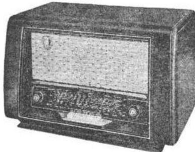
**Nocturne 57.** 7 lampes (EF89, ECH81, EBF80, 6AV6, EL84, EZ80, EM80). 4 gammes OC-PO-GO-BE. Cadre à air blindé. Clavier 5 touches dont commutation PU. HF accordée toutes gammes. HP elliptique 16-24 cm. Tonalité réglable. Ebénisterie noyer, H 360 - L 595 - P300 mm.
