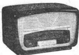
But 57 Standard. 5 lampes (ECH81, 2-EBF80, EL84, EZ80). 4 gammes OC1-OC2-PO-GO. Cadre ferroxcube. Clavier 5 touches dont commutation PU. Bobinages tropicalisés. HP elliptique 13-19 cm. Tonalité réglable. Bakélite marron ou aubergine. H220-L355-P180 mm.
