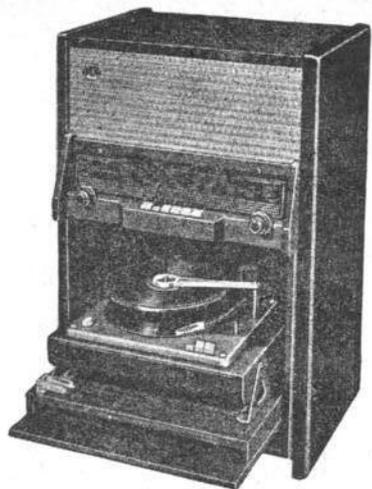
**FF559 AM/FM.** Meuble radio phono 7 lampes (ECC85, ECH81, EF85, EABC80, EL84, EZ80, EM80), 4 gammes OC - PO - GO - FM. Ferrocapteur et antenne OC-FM incorporée. Clavier 6 touches dont arrêt secteur et commutation PU - 2 HP 16 et 21 cm. Tonalité réglable. Changeur de disques 3 vitesses. Meuble acajou, panneaux latéraux bakélite. H900-L560-P400 mm. Prix T.T.C. **115.680**
