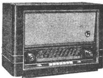
**Savoie-5649 AM/FM.** 9 lampes (2-6BQ7, 6BY7, 6AJ8, 6AK8, 6AV6, 6BQ5, 5Y3GB, EM85). Etage HF cascade accordé. 5 gammes OC-PO-GO-BE-FM. Cadre à air blindé. Clavier 7 touches dont arrêt-secteur et commutation PU. 3 HP : 21 cm, elliptique 10-14 cm, et tweeter électrostatique. 2 tonalités réglables : graves et aiguës. Ebénisterie noyer. H405-L630-
