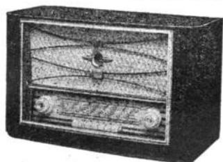
**CL74.** 7 lampes (6AU6, ECH81, 6BA6, EBF80, EL84, EZ80, EM85). Etage HF. 4 gammes OC-PO-GO-BE. Cadre à air blindé. Clavier 5 touches dont commutation PU. HP 17 cm. Tonalité réglable. Ebénisterie noyer H305-L485-P220 mm. — Prix T.T.C., Paris, **29.100**
