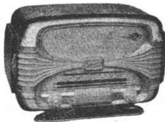
**Surcouf.** 6 lampes + redresseur (EF85, 6AJ8, 6N8, EF80, EL84, EM34, red. B250C75). 4 gammes OC - PO - GO - BE. Etage HF. Cadre ferroxcube. Clavier 5 touches dont commutation PU. HP elliptique 12-19 cm. Tonalité réglable. Ebénisterie noyer. H310-L480-P210 mm.
