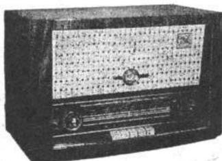
Confort VI. 6 lampes (ECH81, EF 89, EBF80, EL84, EZ80, EM80). 4 gammes OC-PO-GO-BE. Cadre ferroxcube. Clavier 5 touches dont commutation PU. HP 17 cm. Tonalité réglable. Ebénisterie noyer. H330-L500-P280 mm.
