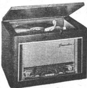
**Montréal 672 RP.** Radio-phono 6 lampes (ECH81, EF89, EABC80, EL84, EZ80, EM85). 3 gammes OC - PO - GO. Cadre à air blindé. Clavier 4 touches dont commutation PU. HP 17 cm. Tonalité réglable. Ebénisterie noyer. H350-L435-P310 mm Prix T.T.C. 46.030
