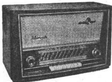
Walkyrie AM/FM. 9 lampes (ECH81, 2-EF85, ECC85, EBF80, EB91, EL84, EZ80, EM85). 6 gammes OC1-OC2-OC3-PO-GO-FM. Cadre à air blindé, et antenne FM incorporée. Clavier 8 touches dont arrêt-secteur et commutation PU. MF accordée toutes gammes. Sélectivité variable 3 HP elliptique 26-16 cm. et 2 de 13 cm. latéraux. Tonalité réglable 3 positions. Ebénisterie palissandre. H360-L570-P240 mm.
