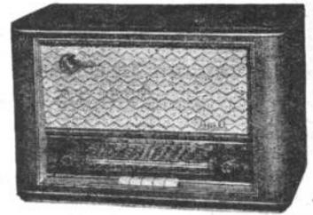
**Synchromatic 756.** 7 lampes (EF80, ECH81, 2-EBF80, EL84, EZ80, EM34). 4 gammes OC-PO-GO-BE. Cadre à air. Clavier 5 touches dont commutation PU. HF accordée. HP elliptique 16-24 cm. Tonalité réglable. Ebénisterie noyer, H340-L520-P270 mm. T.T.C. 36.815
