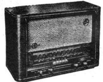
**L 735** 6 lampes (6BE6, 6BA6, 6AV6, 6BQ7, 6BX4, EM85). 4 gammes OC-PO-GO-BE. Cadre ferromagnétique. Clavier 5 touches dont commutation PU. HP 17 cm. Tonalité réglable. Ebénisterie noyer H345-L480-P228 mm. Prix T.T.C. 37.535
