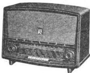
**BF 460A.** 5 lampes (ECH81, EBF80, ECL82, EZ80, EM80). 4 gammes BE - OC - PO - GO. Cadre ferrocapteur, et antenne OC incorporée. Clavier 5 touches dont 1 arrêt-secteur, et combinaisons par 2 touches pour gamme Chalutier (adaptable sur demande) et commutation PU. HP 16 cm. Tonalité réglable. Polystyrène bordeaux ou ivoire, H270-L385-P180 mm. Prix T.T.C. **30.750**
