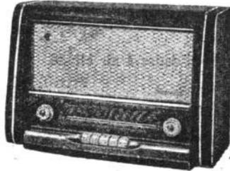
**Arioso.** 6 lampes (2-ECH81, EBF80, EL84, EZ80, EM34). 4 gammes BE - OC - PO - GO. Etage HF accordé toutes gammes. Cadre à air blindé. Clavier 6 touches dont arrêt secteur et commutation PU. HP 19 cm. Tonalité réglable. Ebénisterie noyer. H340-L490-P240 mm.
