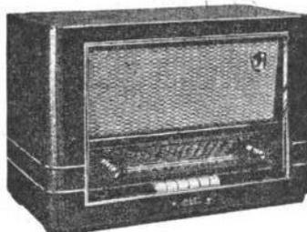
**Dauphiné-5637, 7 lampes (6BQ7, 6AJ8, 6BA6, 6AV6, 6BQ5, 6BX4, EM85).** Etage HF cascade accordé. 4 gammes OC-PO-GO-BE. Cadre à air blindé. Clavier 6 touches dont arrêt secteur et commutation PU. HP 19 cm. Tonalité réglable. Ebénisterie noyer. H350-L1580-P275 mm.
