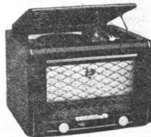
**Radio-phono Bretagne.** 6 lampes (ECH81, EF89, EBF80, EL84, EZ80, EM80). 4 gammes OC - PO - GO - BE. Cadre à air blindé. Clavier 7 touches dont 2 pré-réglées Luxembourg et Europe 1. HP 17 cm. Tonalité réglable. Tourne-disque 3 vitesses. Ebénisterie noyer, H300-L430-P260 mm. Prix T.T.C. 43.705
