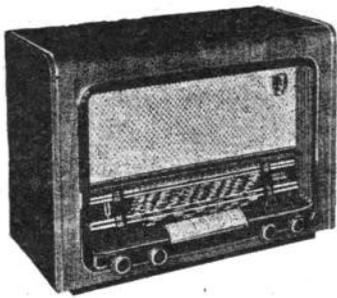
**L 756 AM/FM.** 8 lampes (6BQ7A, 2-6BA6, ECH81, EABC80, EL84, 6BX4, EM85). 4 gammes OC-PO-GO-FM. Cadre à air blindé. Clavier 6 touches dont arrêt secteur et commutation PU. HP elliptique 16-24 cm. 2 réglages de tonalité: aiguës et graves Ebénisterie noyer H375-L520-P293 mm. Prix non fixé.
