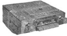
**Modèle MB à circuit imprimé avec haut-parleur de 13 cm, matériel d'antiparasitage.** Ce récepteur comprend 4 lampes, 1 redresseur et reçoit 2 gammes PO-GO ou PO-OC (49 m). Clavier à touches pour le changement de gamme, la tonalité et l'éclairage de cadran. Prix de l'ensemble : 28.800 fr. + t. l.
