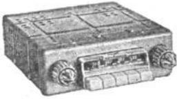
**A2S, récepteurs à présélection automatique,** 6 lampes, 2 gammes PO-GO avec étage HF accordé, puissance 3 watts et **A2P** 8 lampes, 2 gammes PO-GO, avec étage HF accordé, sortie push-pull, puissance 6 watts. Ces deux modèles sont réalisés en deux versions : version continentale PO-GO et version méditerranéenne PO-BE (49 mètres).
