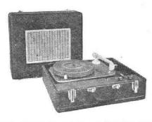
DS551. Electrophone 3 lampes (ECC82, EL84, EZ80). Puissance 3 W (4 W en pointe). 3 HP: 21 cm et 2 tweeters. Voyant lumineux de mise sous tension. Prises pour magnétophone, micro haute impédance et HPS basse impédance. 2 tonalités réglables: graves et aiguës. Tournedisque 3 vitesses, platine Lorenz PS551F. Alternatif 110/220 V, 50 c/s, 25 + 9 VA. Valise gainée vert, couvercle amovible. H225-L410-P360 mm.
