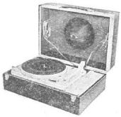
Electrophone IV. 3 lampes (6AV6, EL84, EZ80). HP 19 cm. Puissance 2 W. Tonalité réglable. Contre-réaction sélective. Tourne-disque 3 vitesses. Alternatif 110/245 V, 50 c/s, 35 VA. Valise gainée bordeaux, couvercle amovible contenant le HP. H187-L390-P270 mm. Prix T.T.C. 30.798
