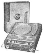
Electrophone, 3 lampes (ECC82, EL84, EZ80). Puissance 5 W. HP 12-19 cm. Voyant lumineux de mise sous tension. Prises pour HPS et pour micro. 2 tonalités réglables. Commutateur 3 positions: haute-fidélité, musique et micro. Tourne-disque 3 vitesses. Alternatif 110/130 et 220/250 V, 50 c/s, 20 + 7 VA. Valise gainée, avec couvercle amovible contenant le HP. H158 - L315 - P360 mm, 7 kg. Prix T.T.C. 36.580
