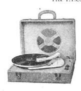
Arcophone 56. Electrophone 3 lampes (UF41, UL41, UY42. HP 21 cm. Puissance 2,5 W. Tonalité réglable. Prise pour micro. Tournedisque 3 vitesses, platine Radiohm. Alternatif 115-230 V, 50 c/s, 23 + 5 VA. Valise gainée, couvercle détachable contenant le HP. H145-L380-P300 mm, 6 kg. Prix T.T.C. 30.823
