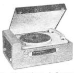
Cadet 56. Electrophone 2 lampes (ECL80, Cadet 56. Electrophone 2 lampes (ECLov, EZ80). Puissance 2 W. HP 12-19 cm. Tonalité réglable. Tourne-disque 3 vitesses. Alternatif 110/220 V, 50 c/s, 15 + 12 VA. Valise gainée 2 tons. H150-L380-L270 mm. 5 kg.
