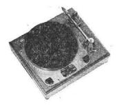
Platine 301 Transcription Motor Garrard. Moteur asynchrone à pôles fendus, 3 vitesses 33-45 et 78 tours, réglables. Plateau Ø 30 cm équilibré, avec disque caoutchouc. Pleurage < 0,2 %, scintillement < 0,05 %. Alternatif 110/220 V, 50 c/s. Equipée avec bras professionnel FR et tête G.E. type RPX 050 A, 2 saphirs. Platine métal, martelé beige. H200-L435-P370 mm. Prix T.T.C. 71.054
