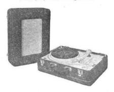
Marly. Electrophone 3 lampes (12AT7, EL84, EZ80). Puissance 4 W. HP 21cm. Prises micro et HPS. 2 réglages de tonalité : graves et aiguës. Tourne-disque 3 vitesses, platine Mélodyne. Alternatif 110/220 V, 50 c/s, 20 + 12 VA. Valise gainée vinyle, couvercle amovible. H190-L410-P 300 mm, 7,8 kg.
