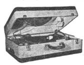
Valise électrophone. 3 lampes (EBF80, EL84, EZ80). HP 21 cm. Puissance 3,5 W. Prises micro et HPS. Tonalité réglable. Contre-réaction sélective. Tourne-disque 3 vitesses. Alternatif 110/220 V, 50 c/s, 30 + 10 VA. Valise gainée beige et marron. Couvercle amovible contenant le HP. H190-L480-P340 mm, 11 kg. Prix T.T.C. 38.560
