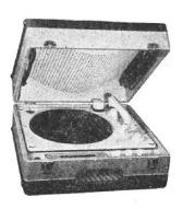
M623. Electrophone. 3 lampes (6CF8, 6BQ5, 6V4). Puissance 3 W. HP 19 cm. Prise micro et prise HPS. 2 tonalités réglables. Tourne-disque 3 vitesses fonctionnant en changeur automatique pour les disques 45 tours. Alternatif 110/245 V, 50 c/s, 40 + 12 VA. Valise gainés 2 coloris. Couvercle amovible contenant le HP. H215-L430-P415 mm, 11 kg.
