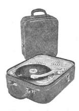
Pil Eden. Electrophone 4 transistors (OC70, 3-OC71). Push-pull 0,4 W. HP 17 cm. Tonalité réglable. Tourne-disque 45 tours, vitesse contrôlée par régulateur électrique incorporé. Alimentation par 4 piles 1,5 V, type torche, débit 30 mA. Mallette fibroïne pécari, emplacement pour 15 disques de 17 cm, couvercle amovible. H120-L360-P280 mm. Livré sans piles.
