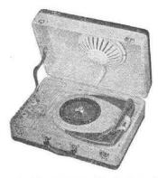
Samba 7. Electrophone 3 lampes (EBF80, EL84, EZ80). Puissance 3,5 W. HP 195 mm. Prise micro (possibilité de brancher un HPS). Tonalité réglable. Contre-réaction sélective. Tourne-disque 3 vitesses, platine Stare. Alternatif 110/220 V, 50 c/s, 30 + 8 VA. Valise gainée 2 tons, couvercle amovible. H165-L430-P315 mm, 7 kg. Prix T.T.C. 30.745
