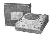
A.543. Electrophone 3 lampes (12AU7, EL84, EZ80). Puissance 5 W. HP 13-18 cm. Prises pour HPS et micro. 2 réglages de tonalité. Commutateur 3 positions : Hi-Fi, musique micro. Tourne-disque 3 vitesses. Alternatif 110-130 et 220-250 V, 50 c/s, 20 + 7 VA. Valise gainée gold ou parchemin, couvercle amovible contenant le HP. H160 - L320 - P360 mm.
