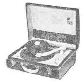
307. Tourne-disque 3 vitesses: 33-45 et 78 tours fonctionnant en changeur automatique pour les disques 45 tours. Alternatif 110-220 V, 50 c/s, 12 VA. Valise gainée cordonal 2 tons. H165 - L415 - P370 mm, 5,5 kg.
