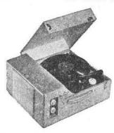
Week-End. Valise électrophone. 4 lampes (2-EF40, 6AQ5, 6X4). Puissance 3,5 W. HP 16-24 cm. Tonalité réglable. Contre-réaction. Tourne-disque 4 vitesses, platine Garrard. Tête pick-up GE. Alternatif 120/220 V, 50 c/s, 30 + 12 VA. Valise gainée parchemin ou bordeaux. H185-L420-P350 mm, 9,5 kg.
