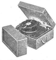
Philharmonic II. Valise électrophone push-pull 6 lampes (12AX7, EF40, 12AU7, 2-EL84, EZ40). Puissance 6 W. 2 HP de 21 cm. 2 réglages de tonalité. Changeur de disques automatique et manuel, platine Garrard 4 vitesses. Tête pick-up GE. Alternatif 120/220 V, 50 c/s, 38 + 19 VA. Valise gainée parchemin ou bordeaux, en 2 parties détachables, l'une formant coffret de HP. H245-L570-P480 mm, 18 kg.
