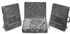
**3VL12.** Electrophone 5 lampes (2-6J6, 2-6V6, 5Y3GB). Puissance 12 W. 2 HP 24 cm contenus en valise 2 éléments détachables, avec 2 cordons de 5 m. 2 réglages de tonalité : grave et aiguë. Contre-réaction. Mélangeur micro-PU. Tourne-disque Lenco F50-84, 4 vitesses par variateur de vitesses à système dou-ble différentiel. Alternatif 110/245 V, 50 c/s, 70 + 15 VA. 2 valises gainées simili-cuir vert. H160 - L540 - P400 mm, ampli 13,5 kg, HP 8 kg.
