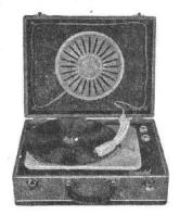
Valise électrophone. 3 lampes (EBC91. EL84, EZ80). Puissance 3 W. HP 21 cm inversé. Tonalité réglable. Tourne-disque 3 vitesses. Alternatif 110/220 V, 50 c/s, 40 + 10 VA. Valise gainée vert et gris, couvercle amovible contenant le HP. H190-L380-P300 mm.
