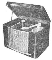
3355S. Coffret électrophone 3 lampes (EF41, EL84, EZ80). Puissance 4 W. 2 HP: 16-21 cm et 1 électrostatique. Tonalité réglable. Tourne-disque 3 vitesses fonctionnant en changeur automatique pour les disques 45 tours. Alternatif 110/245 V, 50 c/s. Ebénisterie noyer avec grille-décor métal doré, et motif lumineux. H336 - L480 - P361 mm, 13 kg. Prix T.T.C. 53.945
