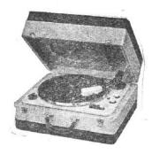
533. Electrophone. 3 lampes (EBF80, EL84, EZ80). Puissance 4,5 W. HP 21 cm, avec Baffle exponentiel. Prise HPS. Tonalité réglable. Contre-réaction fixe. Tourne-disque 3 vitesses, platine CB33N avec tête Duo. Alternatif 110/ 245 V, 50 c/s, 28 + 12 VA. Valise gainée 2 teintes: parchemin et vert, couvercle amovible contenant le HP. H225-L425-P355 mm, 9,2 kg. Prix T.T.C. Paris 52.445
