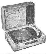
Ambiance. Electrophone 3 lampes (2-ECL80, 6X4). Push-Pull 4 W modulés à < 1 % de distorsion. 2 HP: 19 cm et tweeter 9 cm. Prise HPS. Tonalité réglable. Contre-réaction sélective. Tourne-disque 3 vitesses. Alternatif 110/130 ou 220 V par commutateur 2 positions, 50 c/s, 28 + 12 VA. Valise bois gainé vinyle 2 tons, couvercle amovible. H175-L375-P265 mm, 5,6 kg. Prix T.T.C. 32.649
