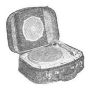
Electrophone. 3 lampes (6N8, 6BQ5, 6V4). Puissance 3 W. HP 17 cm. Tonalité réglable. Tourne-disque 3 vitesses. Alternatif 110/220 V, 50 c/s, 20 + 15 VA. Malette gainée façon pécari. H160-L370-P280 mm, 5,9 kg.
