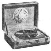
Electrophone. 3 lampes (EBF80, EL84, EZ80). Puissance 3,5 W. Prise pour micro. 2 réglages de tonalité: graves et aiguës. Tourne-disque 3 vitesses, avec cherchour de sillon. Dispositif de court-circuit du PU avec arrêt automatique. Alternatif 110/245 V, 50 c/s, 40 + 12 VA. Valise gainée 2 tons vert et gris. Couvercle amovible contenant le HP. H165-L430-P315 mm, 7 kg..
