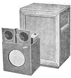
Studium, Ensemble de 4 HP à 3 voies : 31 cm pour les graves, 2 de 21 cm pour les médiums, tweeter à chambre de compression pour les aiguës. Puissance d'utilisation 10 W. Réponse linéaire de 40 à 18 000 c/s. Fourni avec filtre séparateur. Monobloc incorporable en meuble à la demande. H775-L545-P445 mm.
