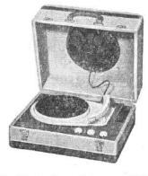
S.T. 23. Electrophone 2 lampes (6V4, 6AB8). Puissance 3,5 W. HP 21 cm. Tonalité réglable. Tourne-disque 3 vitesses. Alternatif 110/220 V, 50 c/s, 25 + 10 VA. Valise gainée 2 tons, couvercle amovible. H 190 - L 390 - P310 mm, 6 kg.
