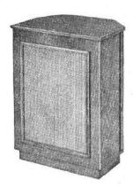
Meuble Ultraflex, modèle Jensen. Enceinte d'encoignure avec 2 fentes latérales étroites réduisant le coefficient de surtention. Volume intérieur 73 dm³. Ensemble KDU10 à 2 voies : HP P8RL Ø 20 cm, graves et médiums, HP à chambre de compression RP103 et pavillon exponentiel pour les aiguës. Filtre séparateur à 3 kc/s, par condensateur. Impédance 8 ohms. Puissance 6 W, pointe 20 W. Ebénisterie H450-L610-P350 mm. Prix T.T.C. 46.272
