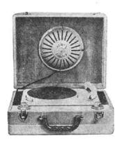
Electrophone. 2 lampes (2-ECL82) et redresseur sec. Push-pull. 5 W. HP 21 cm. Prise HPS. Tonalité réglable par variation de la contre-réaction. Tourne-disque 3 vitesses. Alternatif 110/220 V, 50 c/s, 25. + 15 VA. Valise gainée façon cuir 2 tons: marron et vert, couvercle amovible. H210-L440-P320 mm, 5,5 kg.
