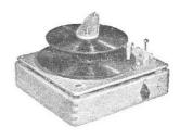
AG1102. Chaîne haute fidélité. Platine 3 vitesses 33-45-78 tours. Changeur automatique 10 disques 25 et 30 cm mélangés. Peut répéter les disques de 17 et 25 cm. Ejection à volonté en cours d'audition. Arrêt automatique. 2 têtes PU haute fidélité: AG3012 saphir 78 tours,
