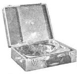
G470A. Electrophone. 2 lampes (UCL82, UY85). HP 17 cm aimant inversé. Puissance 1,3 W (distorsion 10 % à 400 c/s). Platine tourne-disque AG2004, 3 vitesses. Alternatif 120 V, 50 c/s, 16 + 7 VA. Valise gainée
