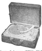
Electrophone. 2 lampes (EF80, EL84, redresseur B250C75). HP 17 cm. Puissance 3,5 W. Tonalité réglable. Tourne-disque 3 vitesses. Alternatif 110/125/245 V, 50 c/s, 25 + 10 VA. Mallette gainée plastic damier vert et noir. Couvercle amovible formant baffle HP. H145-L375-P270 mm, 6 kg. Prix T.T.C. 29.307
