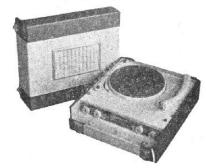
Electrophone. 3 lampes (12AU7, EL84, EZ80). Puissance 5 W. HP 16-14 cm. Voyant lumineux de mise sous tension. Prise HPS, prise micro. 2 réglages de tonalité. Commutateur 3 positions: Hi-Fi, musique, micro. Dispositif « anti-larsen ». Tourne-disque 3 vitesses. Alternatif 110/130 et 220/250 V, 50 c/s, 20 + 7 VA. Valise gainée parchemin, couvercle amovible contenant le HP. H160-L320-P360 mm, 7 kg. Prix T.T.C. 36.580
