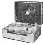
Valise électrophone. 3 lampes (EF41, UL41, UY41). Puissance 2 W. HP 17 cm. Tonalité réglable. Tourne-disque 3 vitesses. Alternatif 120/220 V, 50 c/s, 25 + 15 VA. Valise gainée, couvercle amovible. H165-L300-P240 mm.
