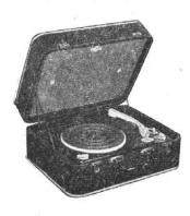
Super J3. Electrophone 3 lampes (UF41, UL41, UY41). Puissance 3 W. HP 21 cm. Prise HPS. Tonalité réglable. Contre-réaction variable. Tourne-disque Lenco J55, 4 vitesses par régulateur magnétique. Alternatif 110-220 V, 50 c/s, 38 + 7 VA. Valise gainée simili cuir 2 tons, lavable, couvercle détachable, contenant le HP. H180 - L410 - P330 mm, 7,6 kg.
