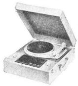
Bagatelle - EP 850. Electrophone 2 lampes (ECC82, EZ80). Puissance 1,5 W. HP 12-19 cm. Prise HPS. Tonalité réglable. Tournedisque 3 vitesses, platine Mélodyne. Alternatif 110/220 V, 50 c/s, 28 VA. Valise gainée plastique lavable blanc, couvercle amovible. H140-L360-P390 mm, 6,5 kg.
