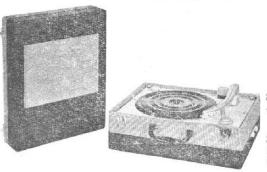
Rapsody. Electrophone 3 lampes (12AT7, EL84, EZ80). Puissance 4 W. HP 16-24 cm. Prise HPS. 2 réglages de tonalité : graves et aiguës. Tourne-disque 3 vitesses, platine Mélodyne, fonctionnant en changeur automatique pour les disques 45 tours. Alternatif 110/220 V, 50 c/s, 20 + 12 VA. Valise gainée 2 tons, couvercle amovible. H210-L420-P330 mm, 10 kg. Prix T.T.C. 40.105
