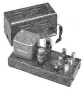
FR203. Amplificateur push-pull 5 lampes 12AT7, 2-6SN7, 2-6B4). Puissance 15 W. Taux de distorsion < 0.3 % à 8 W. Sensibilité d'entrée 340 mV. Réponse droite à  $\pm$  1 db de 20 à 80 000 c/s. Contre-réaction non sélective. Alternatif 110/240 V, 50 c/s. 2 coffrets métal, martelé beige. Amplificateur. H200-L410-P180 mm, 9.6 kg. Alimentation. H190-L320-P150 mm, 10 kg. Prix T.T.C. 110.540
