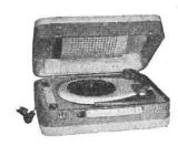
S633. Electrophone. 3 lampes (12AV6, 2-50B5). Puissance 2 W. HP 12-19 cm Prise HPS. Tonalité réglable. Tourne-disque 3 vitesses. Alternatif 110-220 V, 50 c/s, 25 + 8 VA. Valise gainée 2 coloris : bordeaux et gris ou vert et gris. Couvercle amovible contenant le HP. H155-L400-P290 mm, 5,6 kg.
