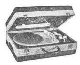
Valise électrophone. 3 lampes (EL84, EBF80, EZ80). Puissance 3 W. HP 21 cm. Tonalité réglable. Tourne-disque 3 vitesses. Alternatif 120-220 V, 50 c/s, 30 + 6 VA. Valise gainée pégamoïd et tissu vinyle vert 2 tons, couvercle détachable formant baffle HP. H160-L440-P300 mm, 4 kg (emballé 4,5 kg).
