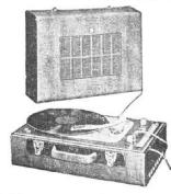
AG9150. Electrophone. 3 lampes (EF80, EL84, EZ80). HP 19 cm aimant inversé. Puissance 2,8 W (distorsion 10 % à 400 c/s). Tonalité réglable pour les aiguës, et 2 positions pour les graves. Prise de modulation. Platine tournedisque AG2004 à 3 vitesses. Alternatif 110/127/220 V, 50 c/s, 28 + 7 VA. Valise gainée pégamoïd lézard, couvercle détachable contenant le HP. H200-L400-P280 mm, 8 kg.
