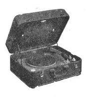
**3VL3 Luxe.** Electrophone 3 lampes (UF41, UL41, UY41). Puissance 3 W. HP 21 cm. Prise HPS. Tonalité réglable. Contre-réaction variable. Tourne-disque Lenco B20, 4 vitesses par régulateur magnétique, d'une tête de PU démontable et d'un diamant. Alternatif 110-220 V, 50 c/s, 38 + 7 VA. Valise gainée simili-cuir natté vert, couvercle détachable contenant le HP. H180 - L410 - P330 mm, 9,7 kg.
