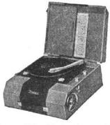
Stéréophone 102. Electrophone. 2 lampes (6AV6, EL84) + redresseur oxymétal. Puissance 4 W. Diffuseur de son avec HP de 10 cm. Courbe de réponse : 30 à 15 000 c/s. Tonalité réglable. Tourne-disque 3 vitesses. Alternatif 110-145-220 V, 50 c/s, 30 + 18 VA. Valise gainée 2 tons. Couvercle amovible pouvant contenir 8 à 10 disques de 17 à 25 cm. H180-L400-P400 mm, 7 kg environ.
