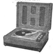
Electrophone M.D. 5 lampes (12AX7, 2-EF86, EL84, EZ80). Puissance 3 W. HP 21 cm. Réponse droite de 20 à 20 000 c/s ± 1 db, distorsion 0,5 %, taux de C.R. 25 db. Prise HPS et magnétophone, et prise micro par jack inverseur. 2 réglages de tonalité : graves et aiguës. Tourne-disque 3 vitesses, platine Radiohm, tête à réluctance variable Goldring 500. Alternatif 110/130 et 220/260 V, 50 c/s, 40 VA. Valise gainée plastique parchemin, couvercle amovible. H235-JL450-P345 mm, 11 kg.
