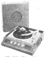
Escale - EP 840. Electrophone 4 lampes (ECC82, ECC83, EL84, EZ80). Puissance 3,7 W. HP 21 cm. Prises HPS et micro. 2 réglages de tonalité: graves et aiguës. Mixage micro-PU. Tourne-disque 3 vitesses, platine Mélodyne, fonctionnant en changeur automatique pour les disques 45 tours. Alternatif 110/ 220 V, 50 c/s, 50 VA. Valise gainée plastique à damier gris clair, couvercle amovible. H185-L410-P445 mm, 10 kg. Prix T.T.C. 44.217
