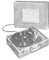
Monaco-E563. Electrophone. 3 lampes (6AV6, 6BM5, 6BX4). Puissance 3 W. HP 19 cm. Bande passante 40 à 12 000 c/s. Tonalité réglable par contre-réaction sélective. Tourne-disque 3 vitesses. Alternatif 110-220 V, 50 c/s, 28 + 8 VA. Valise gainée toile parchemin gris ou 2 tons : gris et bordeaux. Couvercle amovible contenant le HP. H190-L380-P285 mm.
