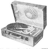
RA437A. Electrophone 3 lampes (EF80, EL84, EZ80). HP 19 cm, aimant inversé. Puissance 3 W. Tonalité réglable. Prise de modulation (magnétophone ou ampli Hi-Fi). Platine tourne-disque 3 vitesses. Alternatif 110-127-220 V, 50 c/s, 28 + 7 VA. Valise gainée, couvercle détachable contenant le HP. H200 - L420 - P330 mm. Prix T.L. en sus 32.500 Prix T.T.C. 33.420
