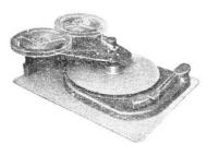
Platine-Enregistreur. Double piste. Adaptable sur tourne-disques 1957 (Pathé-Marconi, Ducretet, etc...). Se pose sur le plateau du tourne-disques sans aucune fixation. Entraînement par plateau de Ø 75 mm garni caoutchouc, reposant sur le plateau du tourne-disques. Peut recevoir des bobines de Ø 18 cm. Utilisable avec amplis et préamplis Oliver. H90 - L270 - P220 mm, 1 kg. Livrée avec mandrin pour
