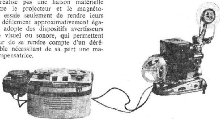
Fig. 2-b. — Synchronisation électromécanique du projecteur muet avec magnétophone à bande perforée ou non
