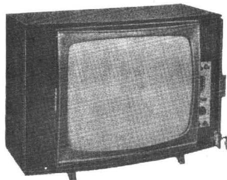
dosage des couleurs. Sensibilité 7 μV. Contrôles automatiques de gain, vision et son. Comparateur de phase incorporé. Alimentation 110/220 V, 50 Hz. Coffret ebénisterie palissandre. Dimensions 50 x 79 x 50 cm. Poids : 63 kg.
