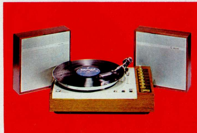
GF 417 ensemble stéréo compact de grand luxe • Platine HI-FI. 2 vitesses 33 et 45 tr/mn, avec plateau de grand diamètre. Bras de lecture tubulaire avec contre-poids et réglage de la force d'appui. Dispositif amorti de levée et descente du bras. Tête de pick-up Stéréo HI-FI Céramique Diamant. Préamplificateur Stéréo incorporé. Amplificateur « tout transistor » de 2 x 7 W à moins de 1 % de distorsion, ou 2 x 10 W à moins de 10 % de distorsion. Contrôles séparés pour graves et aigus. Filtres commutables pour Scratch et Rumble. Balance Stéréo avec indicateur visuel lumineux. Prises pour magnétophone et tuner radio avec sélecteur d'entrée. Prises haut-parleurs (8 ohms). Socle palissandre avec couvercle plastique transparent. Enceintes acoustiques compactes en palissandre contenant chacune 2 haut-parleurs avec filtres de coupure. Dimensions : Ensemble Platine Ampli. 410 x 285 x 160 mm (avec couvercle). Enceinte acoustique : 245 x 245 x 75 mm.
