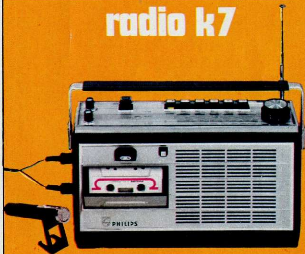
RL 673 - Radio K 7 - à modulation de fréquence • 4 gammes PO-GO-OC-FM - 38 transistors et diodes - Prise pour écouteur ou haut-parleur - antenne extérieure, tourne-disques, microphone, commande à distance et alimentation extérieure - Tonalité continue - H.P. : 10 cm - Puissance : 1,4 W - Alimentation 5 piles 1,5 V - Coffret gainé souple, anthracite - L. 315 x H. 180 x P. 90 mm.
