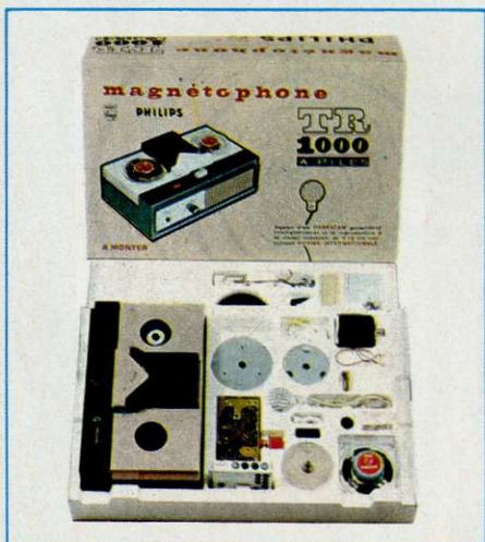
TR 1000 - magnétophone • Très fidèle, le TR 1000, équipé d'un microphone à cristal, enregistre aussi bien la musique que la parole (durée d'enregistrement : 1 heure). Son entraînement par cabestan donne une vitesse de défilement constante (4,75 cm/sec.). Ceci permet d'écouter sur le TR 1000 des bandes enregistrées sur n'importe quel autre magnétophone. Livré avec 2 bobines dont une chargée.
