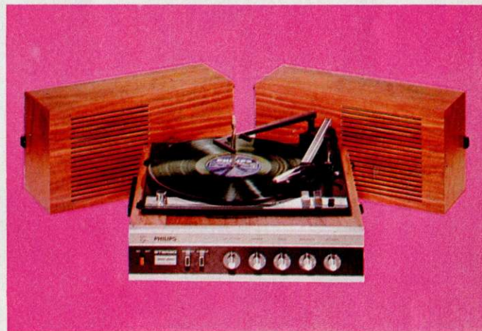
GF 446 électrophone stéréo changeur « de luxe » • Platine 4 vitesses, fonctionnant en manuel, automatique ou changeur tous disques mélangés. Amplificateur « tout transistor » de 2 x 6,5 W. Contrôles de tonalité séparés pour graves et aigus. Balance avec indicateur visuel. Filtres commutables pour Scratch et Rumble. 1 H.-P. de 17 cm dans chaque demi-couvercle. Prises magnétophone et tuner radio, avec sélecteur d'entrée. Coffret noyer, avec poignée de transport. 385 x 385 x 220 mm.
