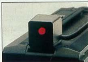
AV 5021: Lampe témoin d'enregistrement (Tally lamp).
