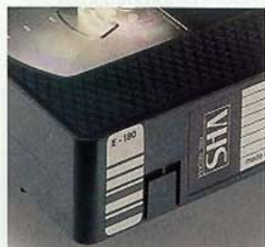
Étiquette "code barres" identifie la longueur de la cassette.
