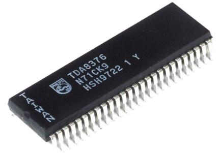
Il existe une version en composant de surface avec boîtier QFP à 64 broches et une version classique utilisée par Grundig en boîtier SDIP dont voici le détail des 52 broches :
